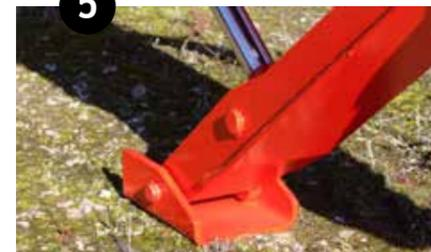
**Hydraulischer Abstellfuß mit Anpassender Fußplatte**
