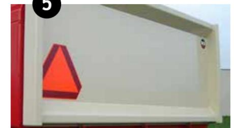
Abgeschrägte Ecken an der Heckklappe
